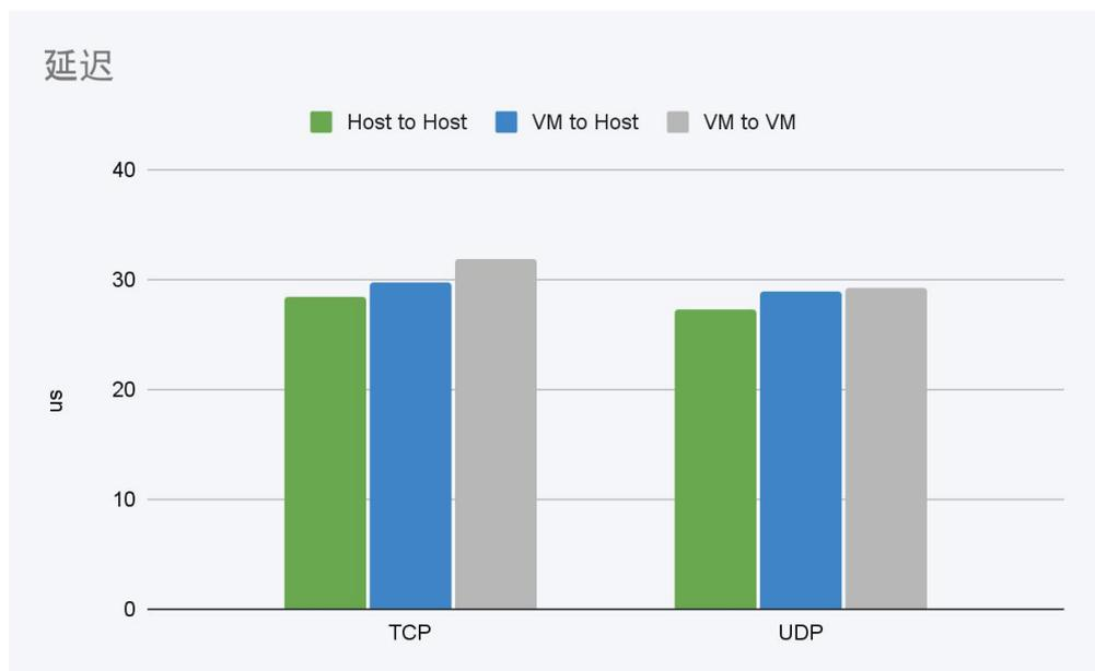
将 PCI 物理网卡直通给虚拟机后，网卡的延迟会有小幅提升；提升是因为虚拟机的网络栈必须绕过虚拟化层直接与物理网络适配器通信，使用 PCI 直通网络设备可能会引入额外的开销，例如中断处理和内存访问。这种开销的影响在 TCP 流量中更加明显，因为相对于 UDP 流量，TCP 流量往往涉及更频繁和更小的数据包。
