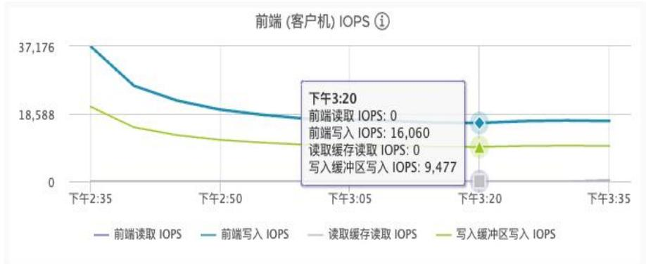
通过上面的测试可以发现，vSAN 采用读写缓存空间各自独立，在容量较大的数据请求场景中存在缓存介质无法充分利用的情况，容易发生缓存击穿导致存储性能下降。
