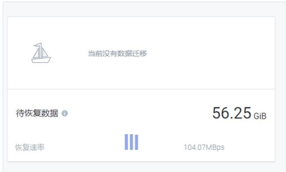
6. 虚拟机 vm-01 中停止 Fio 命令，观察到 node-01 数据恢复速度从 100 MiB/s 逐步提高至 500 MiB/s
