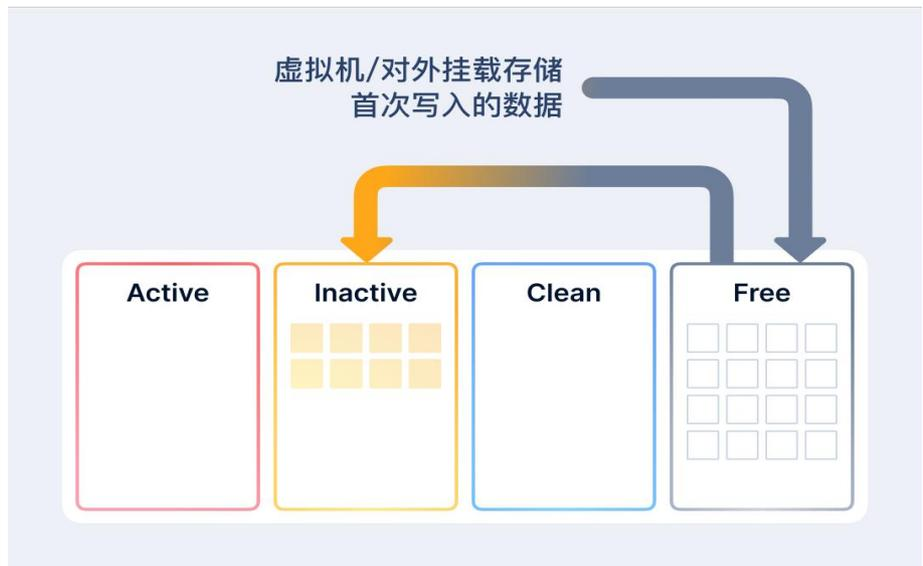
Active 中记录了被访问过多次的数据块，当 Active 的数据超过 Inactive 后，将 Active 数据按照被访问的先后顺序进行排序，不经常被访问的数据会转移记录到 Inactive 中，直到两者的容量相同。
