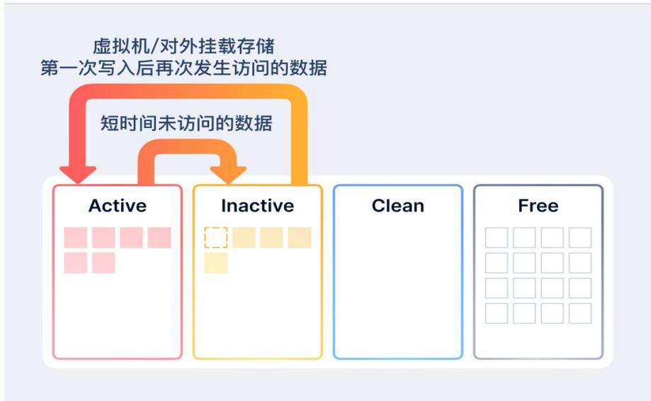
同时当 Active 和 Inactive 的数据容量超过 Cache 空间的 20% 之后，Inactive 数据将开始触发落盘操作，按照时间先后顺序进行排序，排名靠前的早期数据会被写入到 HDD 并在缓存层中被标记为 Clean（此时 Clean 数据在 HDD 和 Cache 中各有一份），后续当 Clean 数据有访问请求时会被重新标记为 Active，否则将被回收为可用空间供写入新数据使用。
