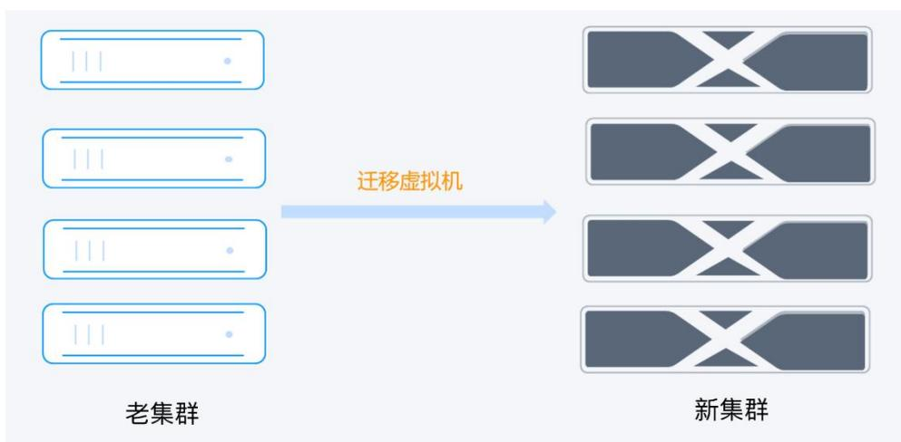
利用新服务器组建一个新集群，将原集群的虚拟机通过跨集群迁移的方式迁移至新集群，从而完成服务器的平滑升级。
