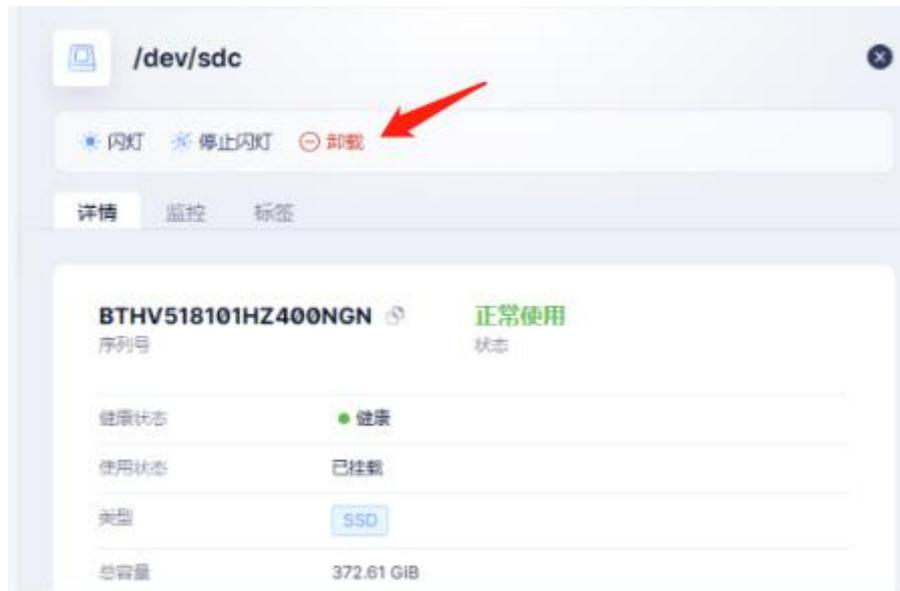
**step 4** 硬盘卸载完成后，状态变更为“未挂载”（卸载时间和硬盘上数据多少有关）。如果计划换盘，建议提前点击卸载硬盘，等到卸载完成以后，再到机房现场进行更换。
