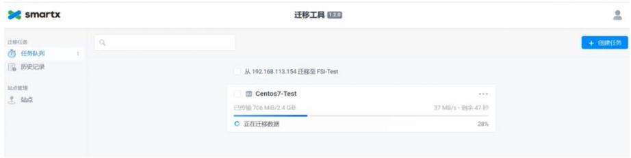
当全量快照传输完成后，可以看到关闭源端虚拟机的提示。当确认关闭源端虚拟机后，迁移工具会将上次创建快照后发生的数据变化，以增量快照的形式传输至目标端站点，来完成数据迁移；数据迁移完成后，可前往目标端站点对虚拟机进行必要的配置和检查。
