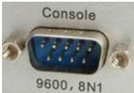
DB-9格式的Console口
