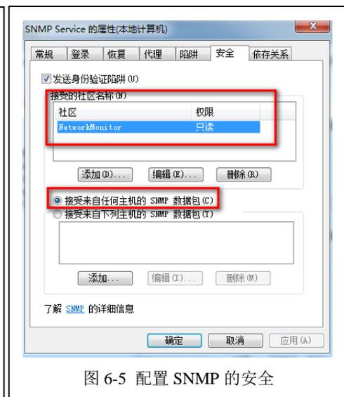
图 6-5 配置 SNMP 的安全
