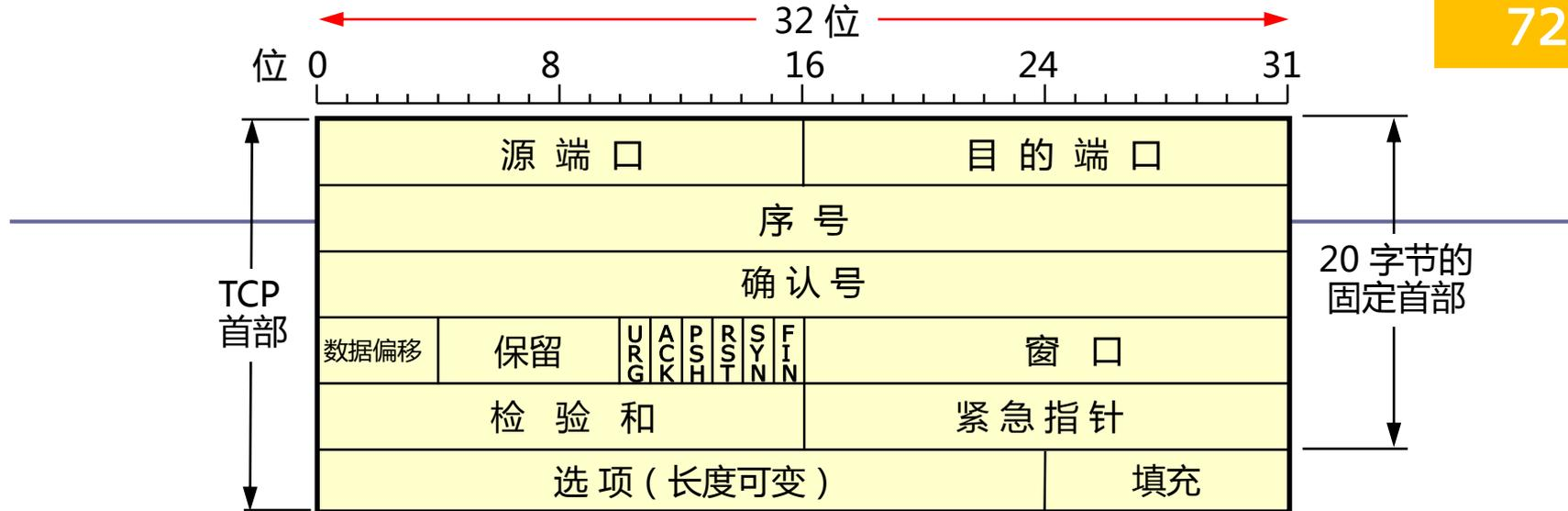
**数据偏移 (即首部长度) :** 4位。它指出TCP报文段的数据起始处距离TCP报文段的起始处有多远。“数据偏移”的单位是32位字 (以4字节为计算单位)。因此TCP报文段首部最大长度为： $(2^4-1)*4$ 字节=60字节。
