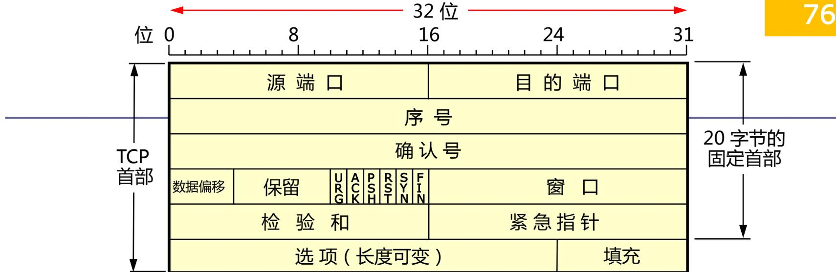
**检验和**：2字节。检验和字段检验的范围包括首部和数据这两部分。和UDP用户数据报一样，在计算校验和时，要在TCP报文段的前面加上12字节的伪首部。伪首部的格式和UDP用户数据报的结构一样，但要把协议号修改为6。校验和的计算方法和UDP用户数据报的计算方法相同。
