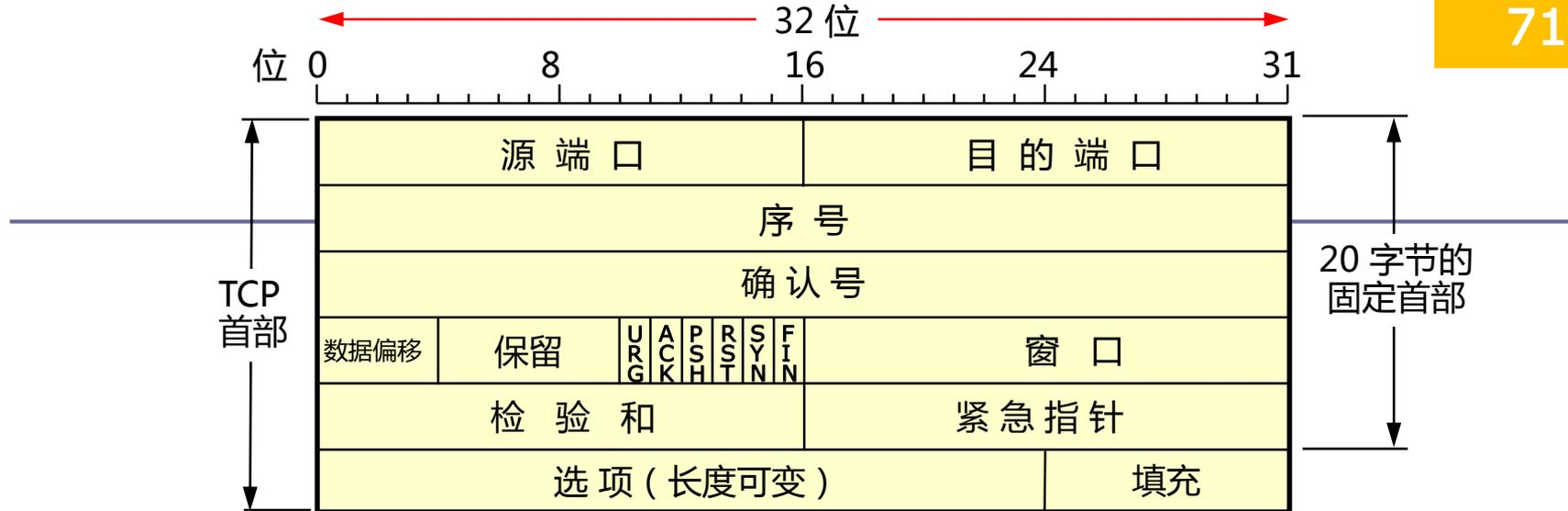
**源端口和目的端口字段**：各2字节。端口是运输层与应用层的服务接口。运输层的复用和分用功能都要通过端口才能实现。
