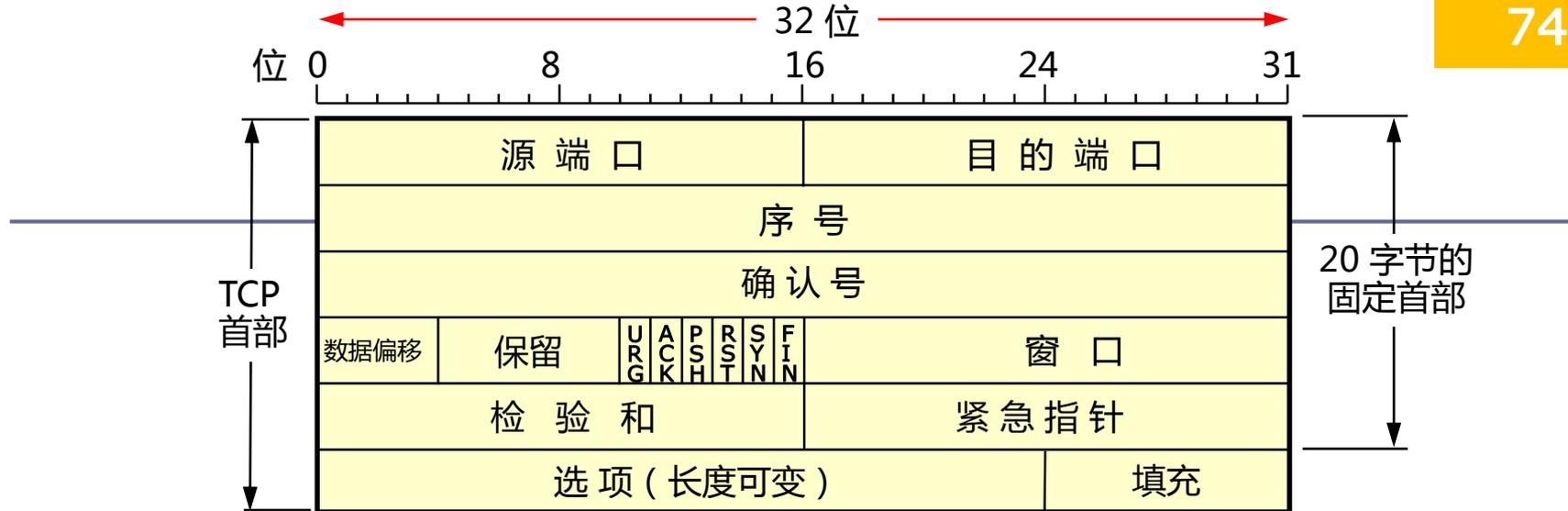
**复位RST(ReSeT)**：1位。当RST=1时，表明TCP连接中出现严重差错（如主机崩溃或其他原因），必须释放连接，然后再重新建立运输连接。
