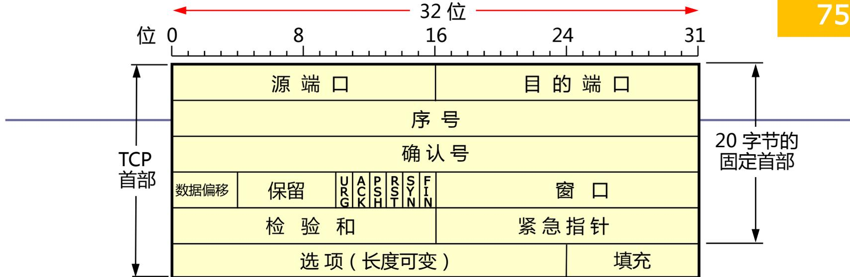
**窗口**：2字节。窗口指的是发送本报文段的一方的接受窗口。窗口值告诉对方：从本报文段首部中的确认号算起，接收方目前允许对方发送的数据量。由于接收方的数据缓存空间是有限的，窗口值作为接收方让发送方设置其发送窗口的依据。其数据单位为字节。在ACK=1时才有效。
