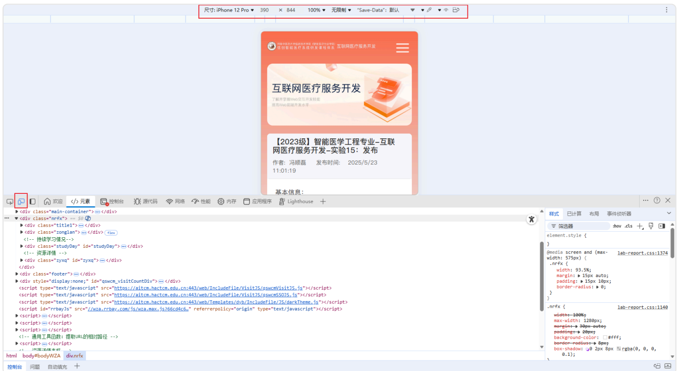
图1 开发者工具的设备模拟模式
