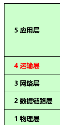
五层协议的体系结构
