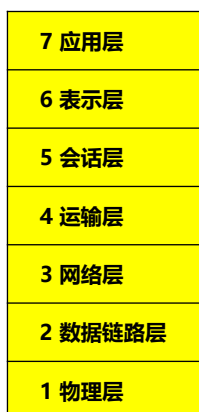
OSI 的七层协议体系结构
