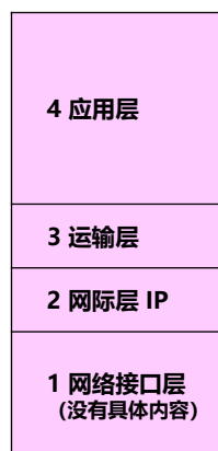
TCP/IP 的四层协议体系结构
