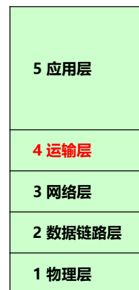
五层协议的体系结构
