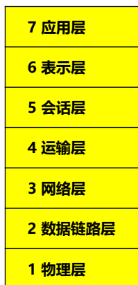
OSI 的七层协议体系结构
