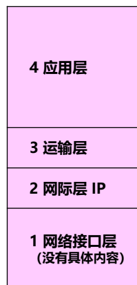
TCP/IP 的四层协议体系结构
