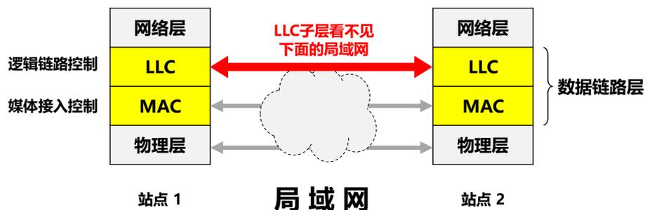
逻辑链路控制 LLC (Logical Link Control) 子层：与传输媒体无关。
