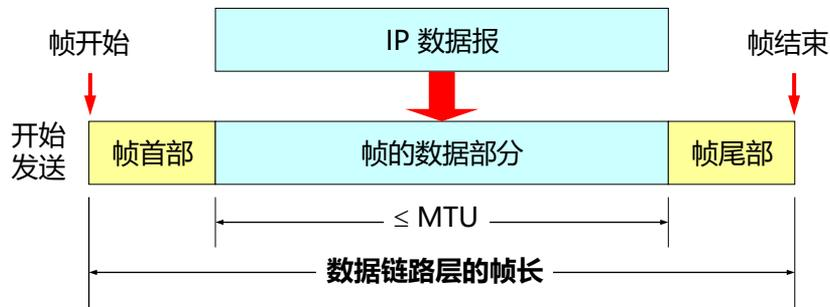
**最大传送单元 MTU (Maximum Transfer Unit)：规定了所能传送的帧的数据部分长度上限。**
