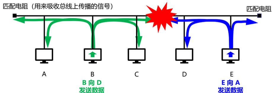
多个站点同时发送时，会产生发送碰撞或冲突，导致发送失败。
