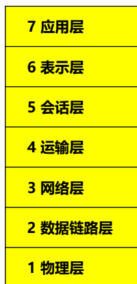
OSI 的七层协议体系结构
