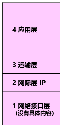
TCP/IP 的四层协议体系结构
