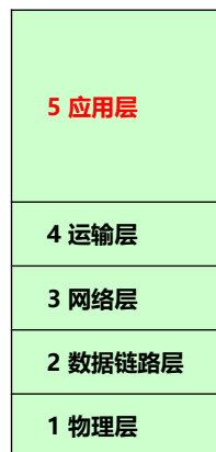
五层协议的体系结构
