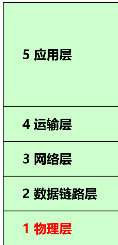
五层协议的体系结构
