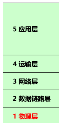
五层协议的体系结构
