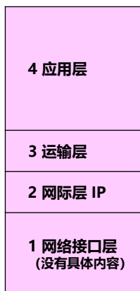
TCP/IP 的四层协议体系结构
