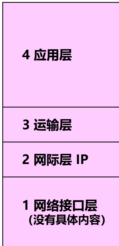
TCP/IP 的四层协议体系结构
