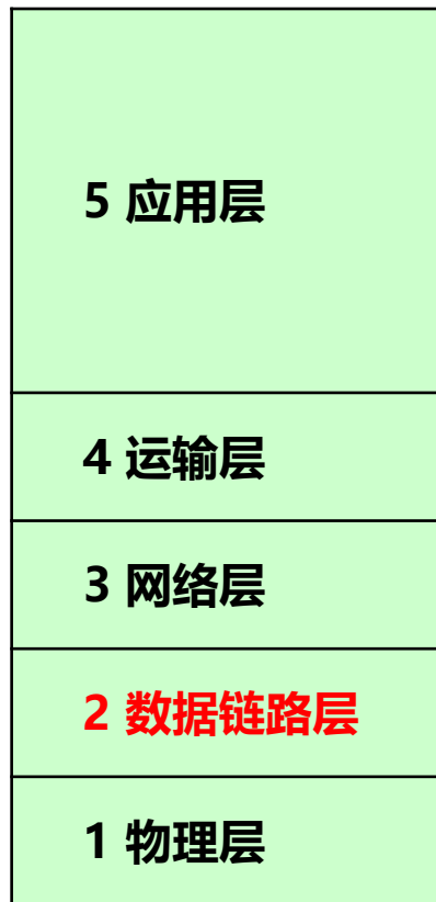
五层协议的体系结构
