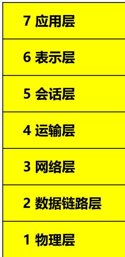
OSI 的七层协议体系结构
