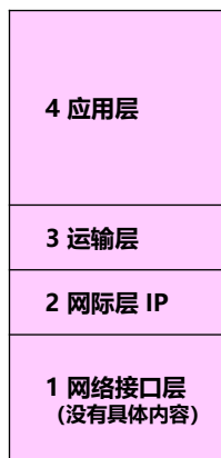
TCP/IP 的四层协议体系结构
