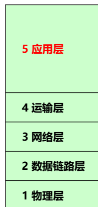
五层协议的体系结构
