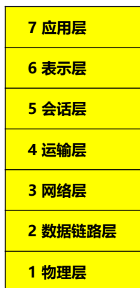
OSI 的七层协议体系结构
