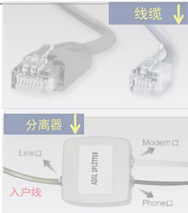
所谓调制，就是把数字信号转换成电话线上传输的模拟信号；解调，即把模拟信号转换成数字信号。合称调制解调器。
