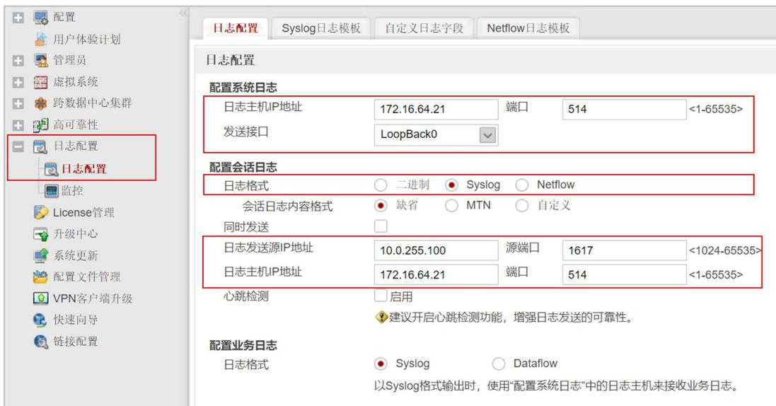
图-2 在防火墙中进行日志配置
