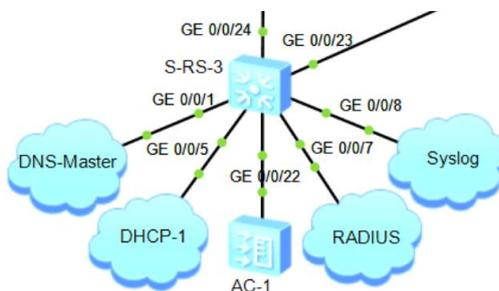
图-1 将日志服务器 Syslog 接入 S-RS-3 的 GE0/0/8 接口
