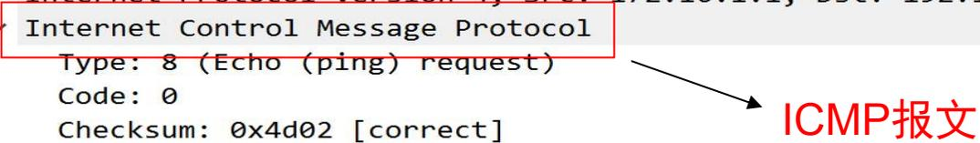
**分析2:** 解封装后，报文的协议显示为ICMP，源IP就是SSL VPN虚拟网关指派的内网IP（172.16.1.1），目的IP为内部网主机A-C-1（192.168.64.10）的IP地址，并且该报文不再加密，
