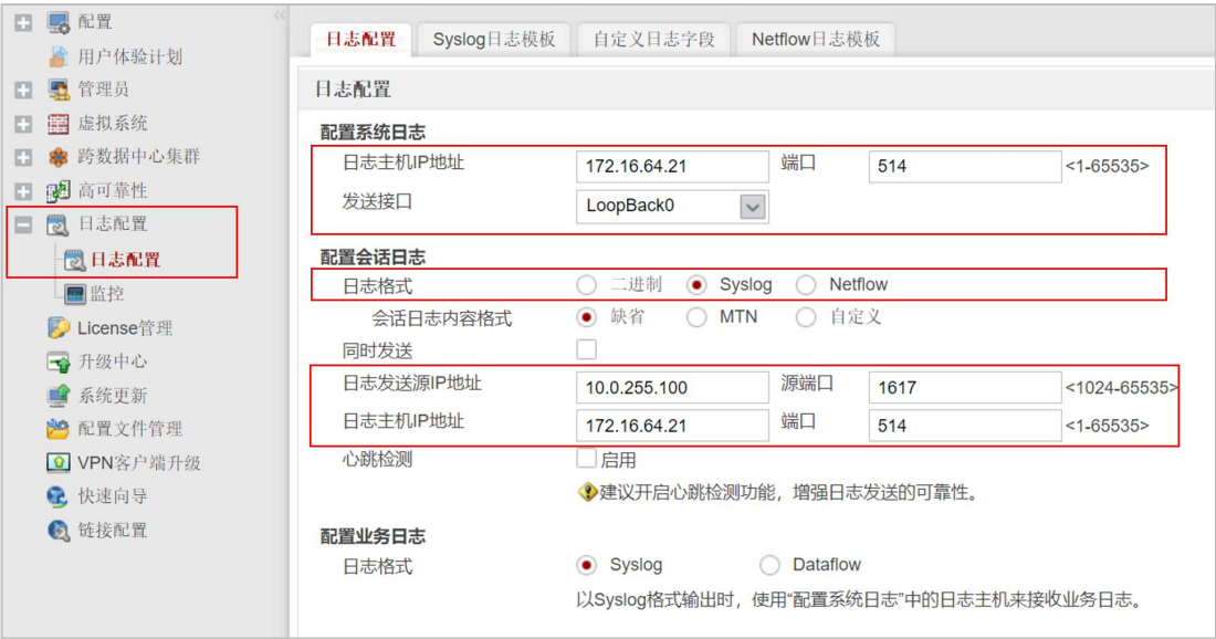
图 11-2 在防火墙中进行日志配置
