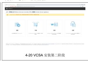
(6) 进入 VCSA 安装第二阶段,如图 4-20 所示,点击【设置】,输入 root 用户密码,进入第二阶段安装,如图 4-21 所示,点击【下一步】,进入设备配置。
